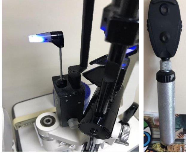
Resim 3: Biomikroskopa monte edilmiş Goldman aplanasyon tonometresi (soldaki resim) ve direk oftalmoskop (sağdaki resim).
